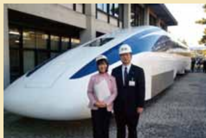
鉄道総研入口にあるリニアモーターカーMLX01(超電導磁気浮上式鉄道車両)。2003年に有人で時速581kmを達成。
